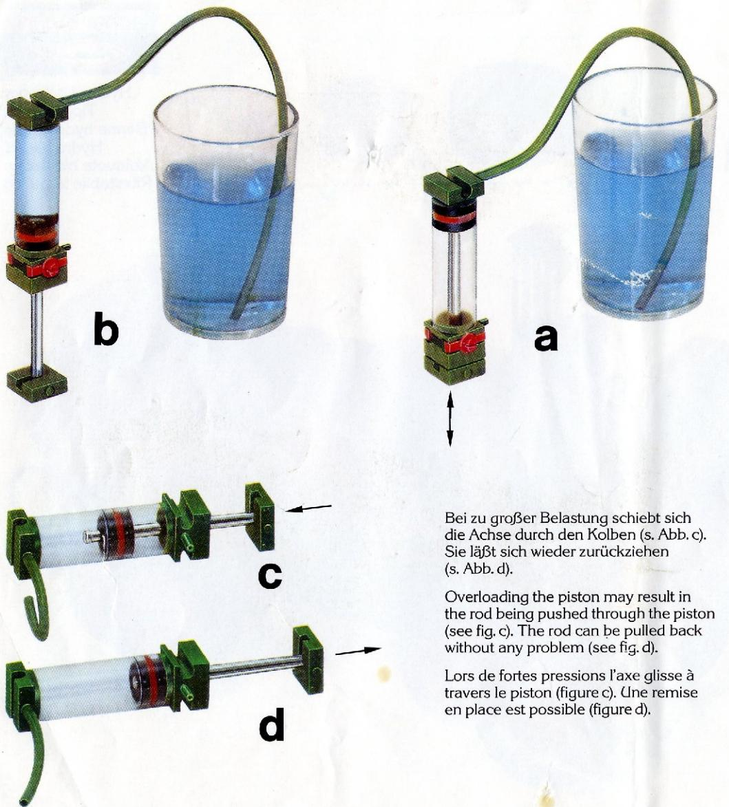
Bei zu großer Belastung schiebt sich die Achse durch den Kolben (s. Abb. c). Sie lässt sich wieder zurückziehen (s. Abb. d).
